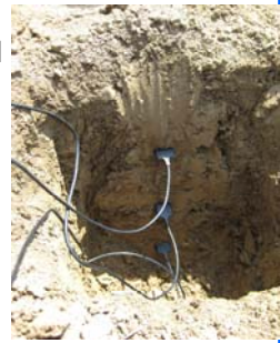
Ejemplo de sondas FDR colocadas a distintas profundidades.
